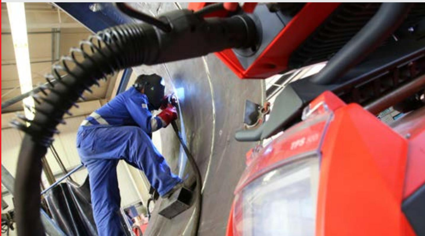
*“En el primer plano siempre está para nosotros la calidad del cordón de soldadura. Lo mismo lo aplicamos a las posiciones unilaterales de la raíz que suponen una parte considerable de los trabajos necesarios para la fabricación del blindaje de pozos”.*
